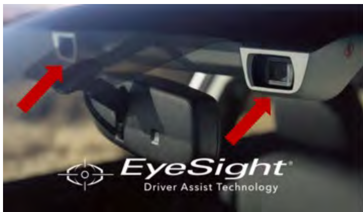
Figure 2. Subaru’s dual ADAS camera system. (Image: Subaru)
